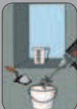
Mörtel trocken vormischen. Erst Wasser, dann Mörtel in den Mischbehälter. 3 Min. mischen bei 300-400 U/min.
