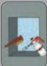
Öffnung reinigen und Bauteillaubung vornässen.
